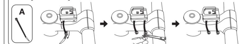
B. Befestigen der Halterung am Lenker
