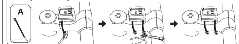
B. Befestigen der Halterung am Lenker
