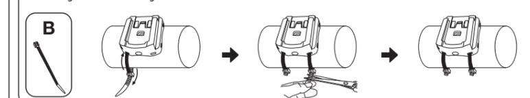
C. Montage von Sensor und Magnet
