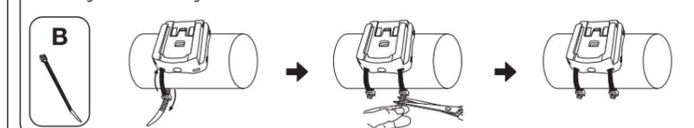
C. Montage von Sensor und Magnet
